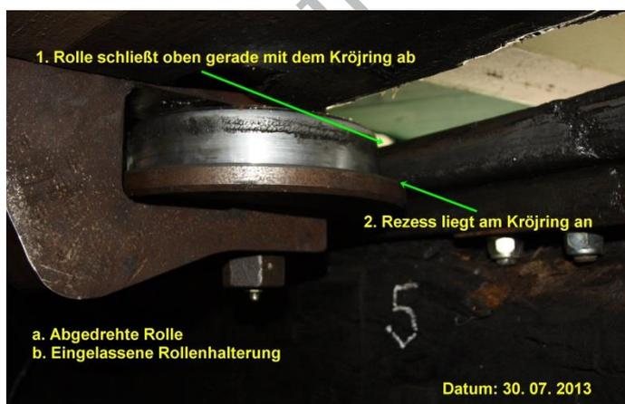
Bild 2: Ordnungsgemäße Gleitrolle unter dem Rösterboden
